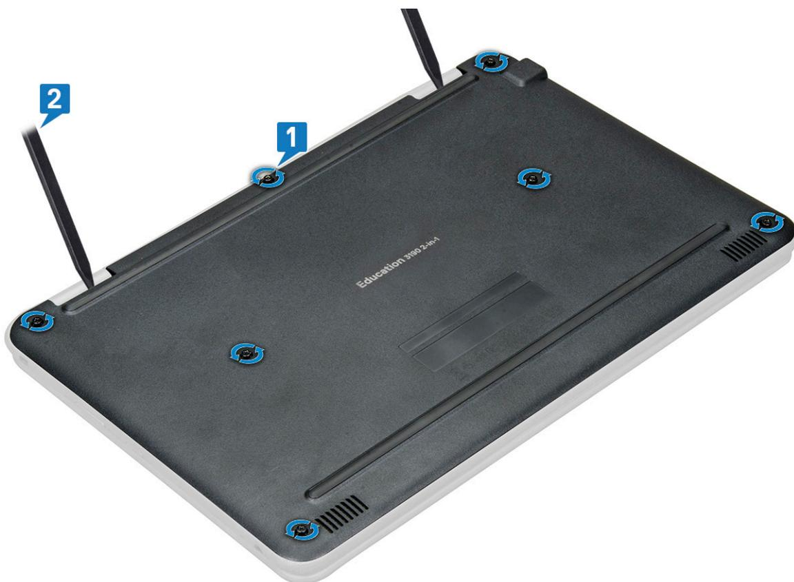
3. Levante la cubierta de la base para extraerla de la computadora.
