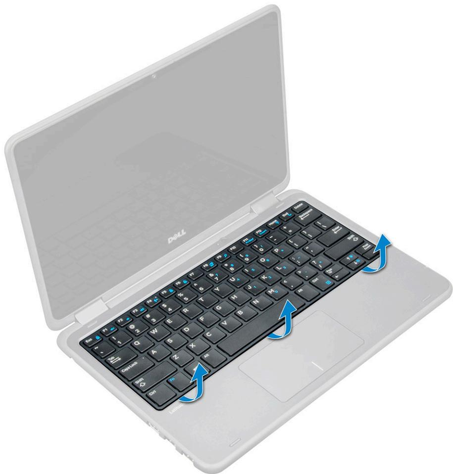
6. Deslice el teclado hacia fuera de la computadora y levántelo para extraerlo de la computadora.
